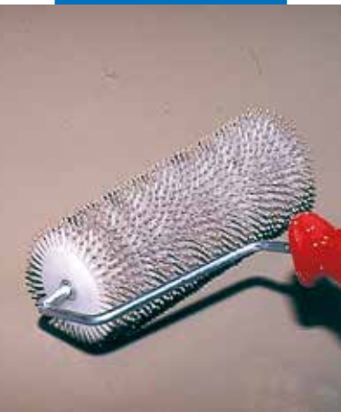
Odpowietrzanie zaprawy za pomocą kolczastej rolki
