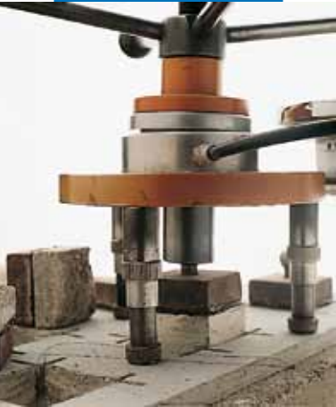
Badanie przyczepności metodą SATTEC
